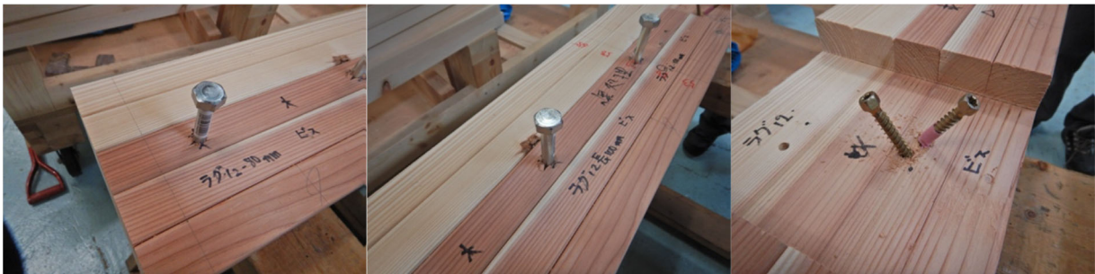
ラグスクリー 外径12mm、首下長さ125mm ラグスクリー 外径12mm、首下長さ150mm スクリービス 外径8mm、全長140mm
