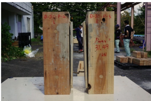
写真 9 最終破壊形状(D-SC-P-4)
