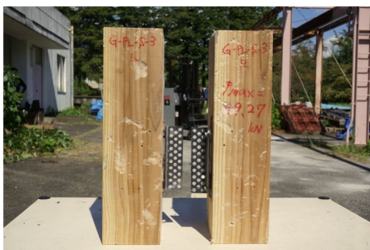
写真 15 最終破壊形状 (G-PL-S-3)
