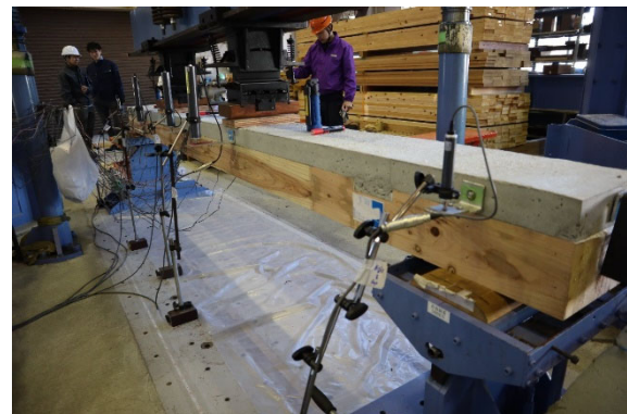
写真 20 計測機器の配置状況
