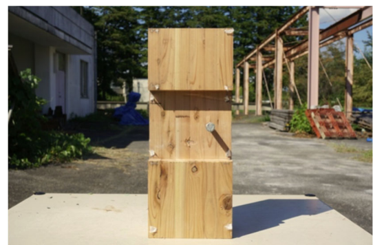
写真 17 最終破壊形状 (G-NL-S-3)
