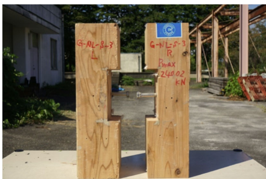
写真 17 最終破壊形状 (G-NL-S-3)
