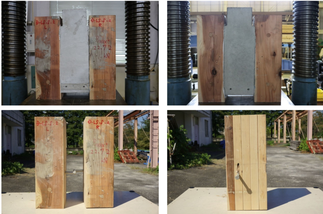
写真 6 最終破壊形状 (D-LS-S-2)
