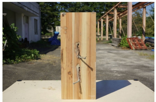
写真 14 最終破壊形状 (G-SC-S-2)
