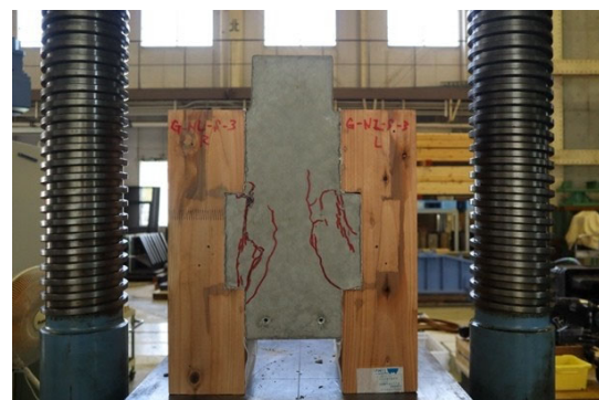
写真 16 最終破壊形状 (G-NN-S-4)
