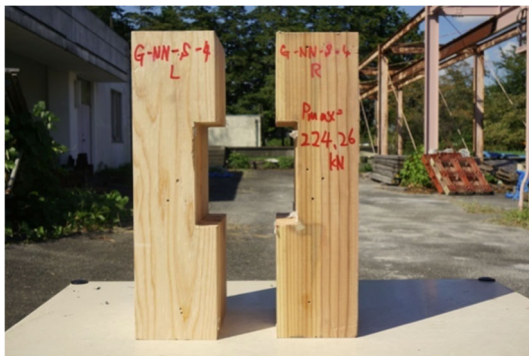
写真 16 最終破壊形状 (G-NN-S-4)
