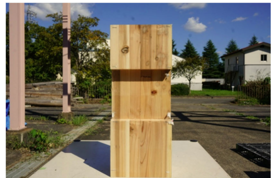
写真 16 最終破壊形状 (G-NN-S-4)
