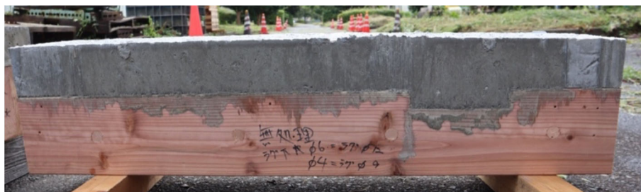
写真 43 脱型時の側面（無処理）
