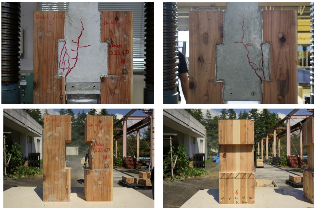
写真 11 最終破壊形状(D-NN-S-3)
