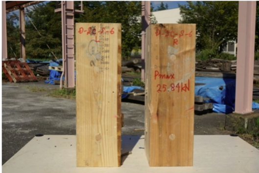
写真 8 最終破壊形状(D-SC-S-6)
