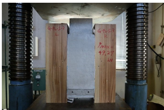
写真 14 最終破壊形状 (G-SC-S-2)
