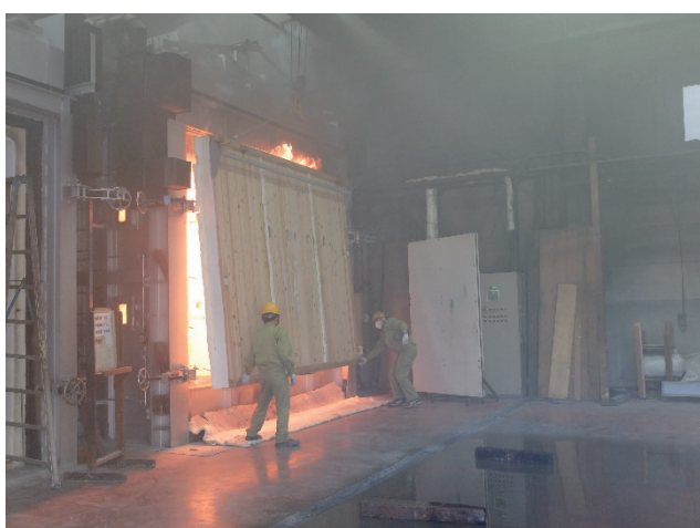
写真 62 試験体A 脱炉
