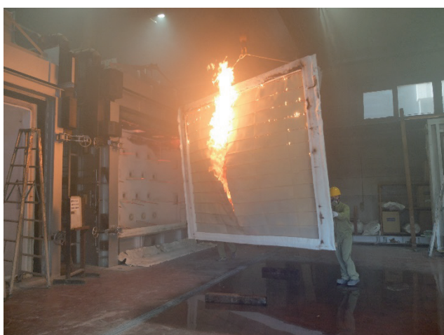
写真 64 試験体A 脱炉
