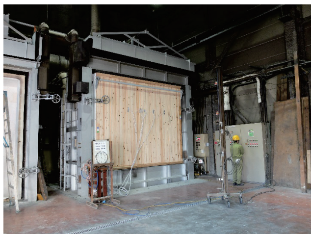
写真 52 試験体A 加熱開始
