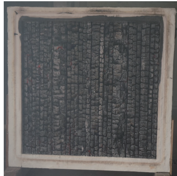
写真7 試験体A 試験後
