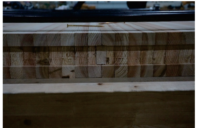
写真 35 DLTパネル 接合部拡大
