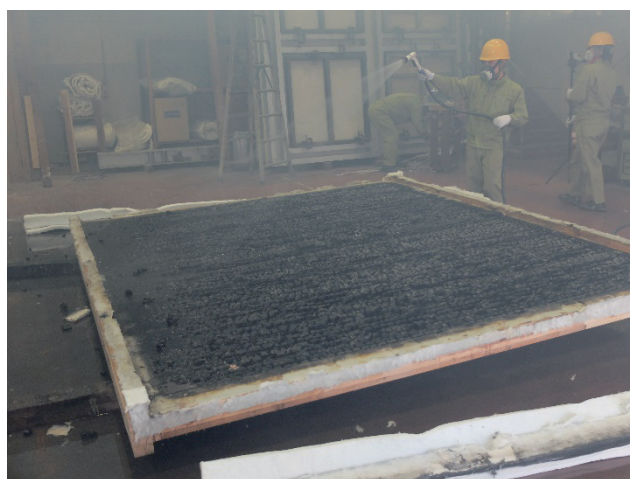
写真 83 試験体B 消火状況
