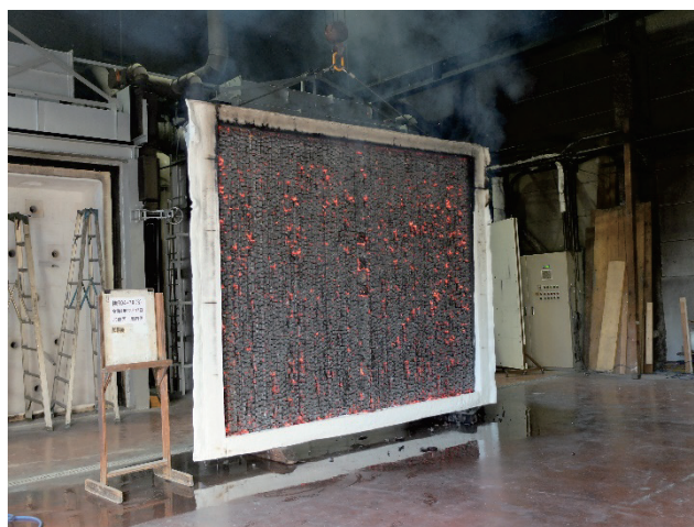
写真 81 試験体B 脱炉後 加熱面
