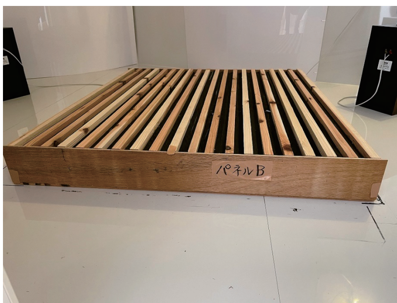
写真 91 吸音パネルB
