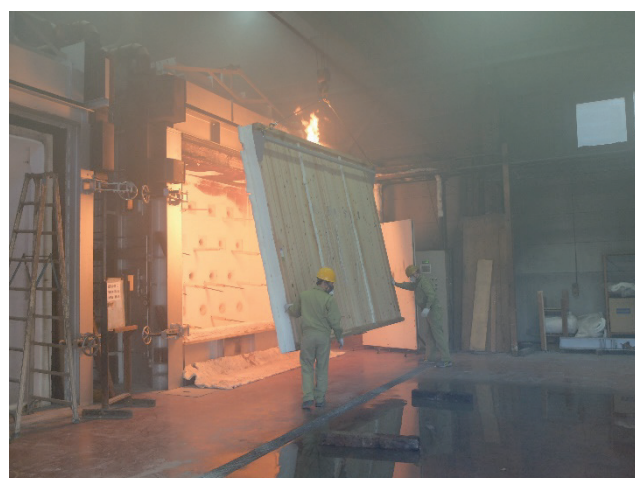
写真 63 試験体A 脱炉
