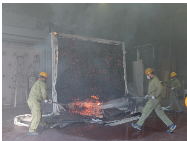
写真 66 試験体A 脱炉後 加熱面
