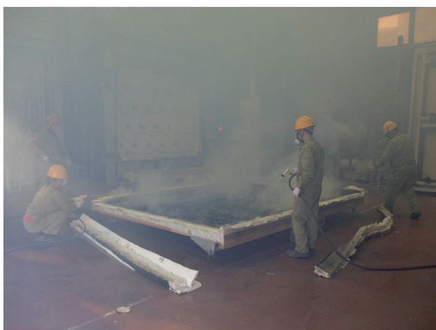
写真 82 試験体B 消火状況
