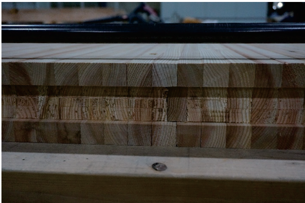
写真 34 DLTパネル 接合部拡大
