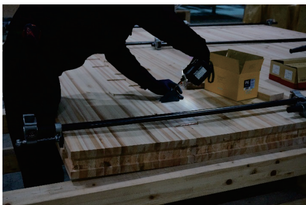
写真 30 DLTパネル 接合
