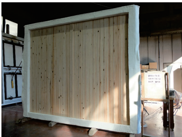
写真 69 試験体B 試験前 加熱面
