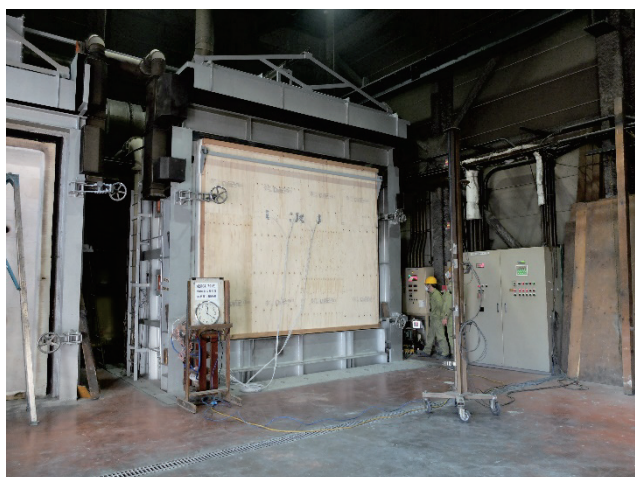
写真 74 試験体B 20分経過
