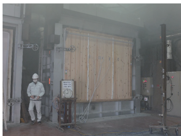
写真 61 試験体A 45分 加熱終了
