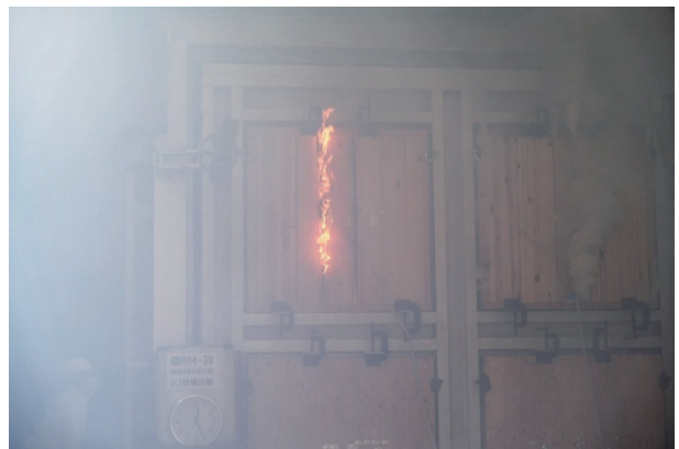
写真 21 加熱試験 試験体Bで火炎貫通
