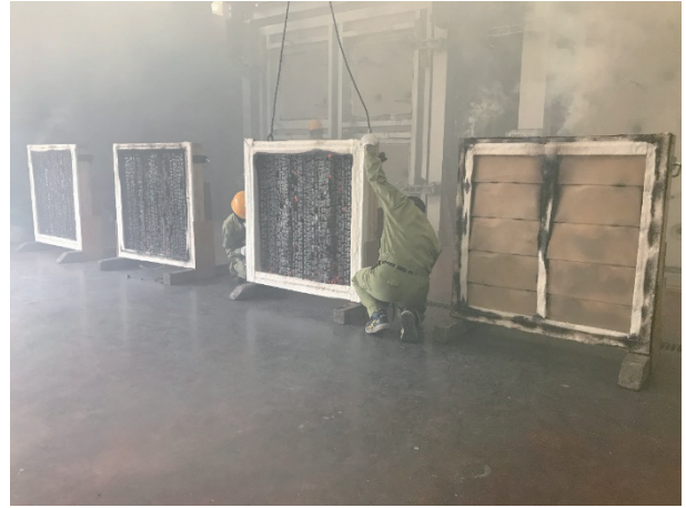
写真 19 試験体 脱炉後
