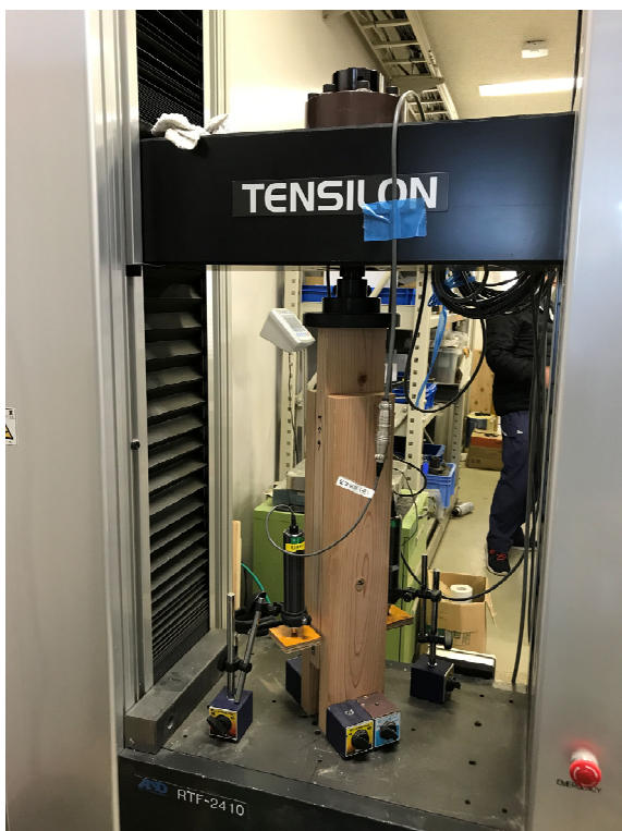
写真 12 ヤマザクラ せん断試験状況（繊維方向）
