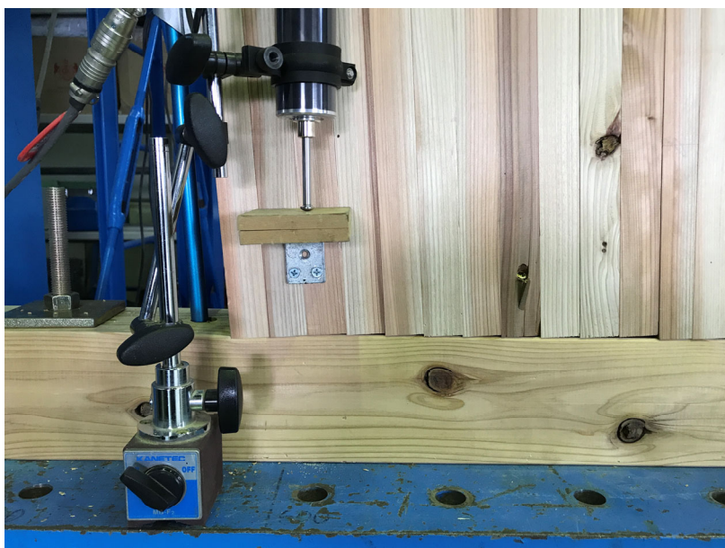
写真 24 試験体 A 終了時 土台めり込み状況
