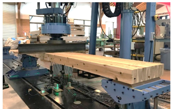
写真2 DLT曲げ試験状況
