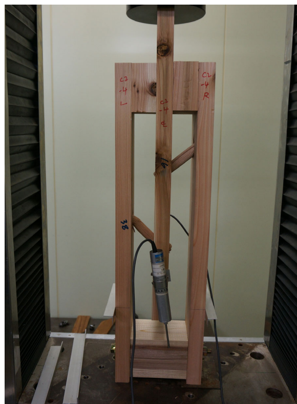
写真 18 C2 せん断試験状況
