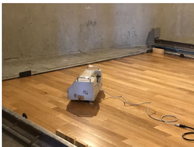
写真 34 重量衝撃音 試験状況
