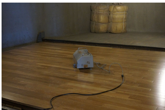
写真 44 重量衝撃音 試験状況
