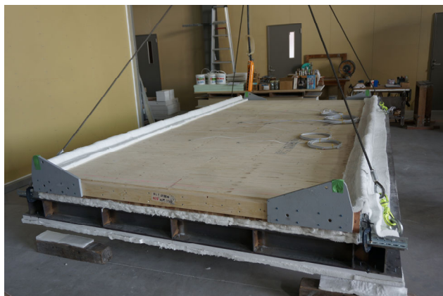
写真 46 試験体 断熱状況
