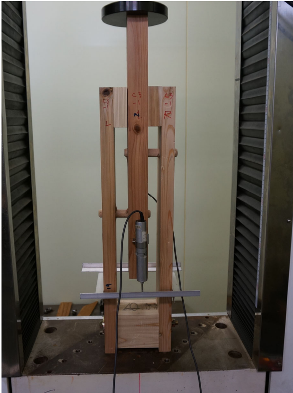
写真 19 C3 セン断試験状況
