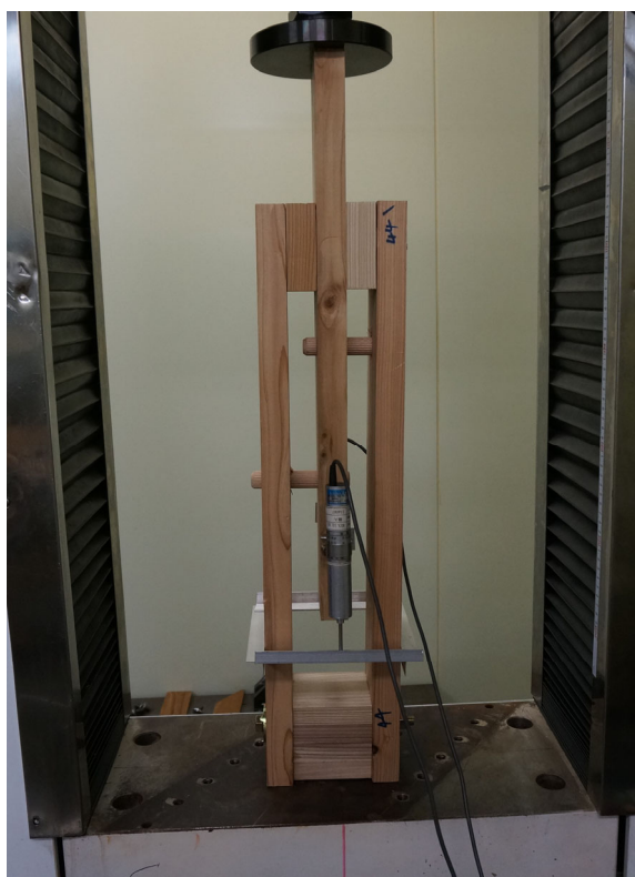
写真 17 C1 せん断試験状況
