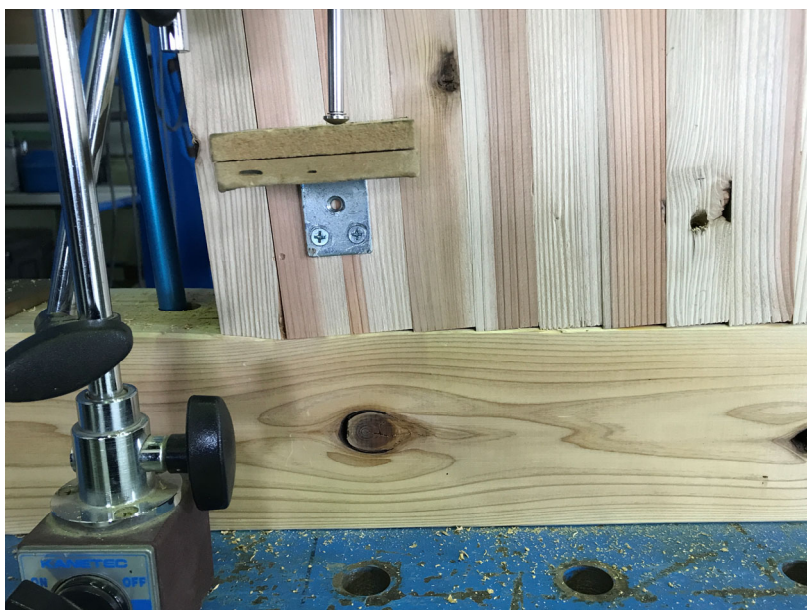
写真 28 試験体 B 終了時 土台めり込み状況
