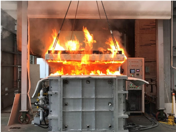
写真6 小型試験炉で加熱試験・脱炉状況
