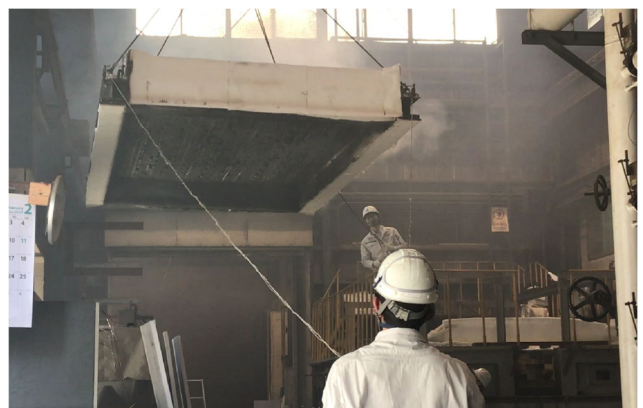
写真 53 試験体 加熱終了・脱炉状況
