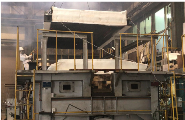
写真 52 試験体 加熱終了・脱炉状況
