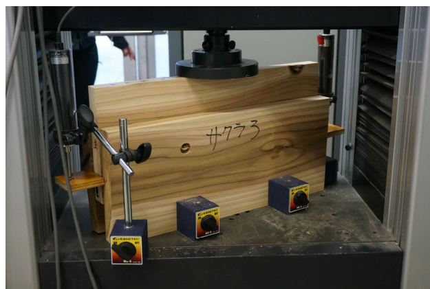
写真 15 ヤマザクラ せん断試験状況（繊維直角方向）
