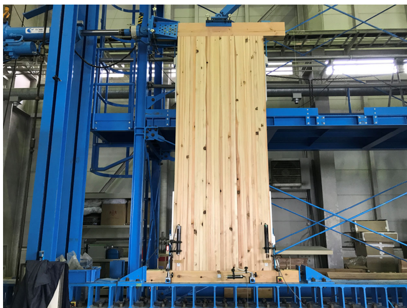
写真 25 試験体 B 面内せん断試験 開始時
