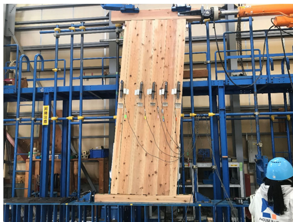
写真3 耐力壁 面内せん断試験状況
