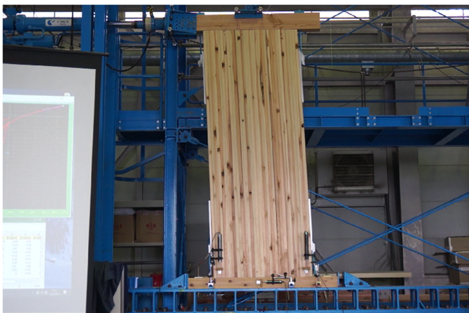
写真 22 試験体 A 面内せん断試験 終了時
