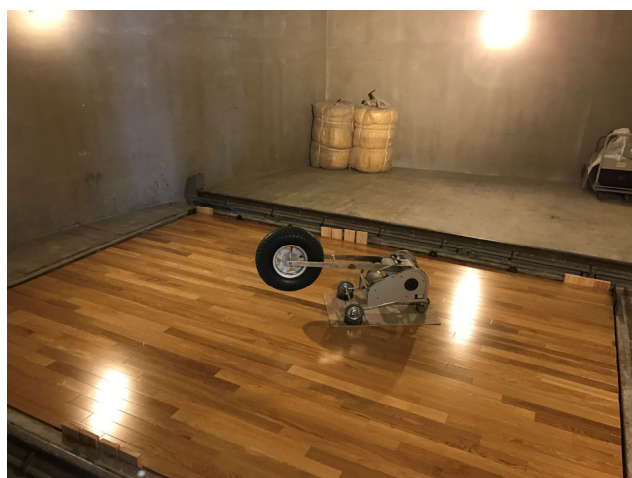
写真 33 重量衝撃音 試験状況
