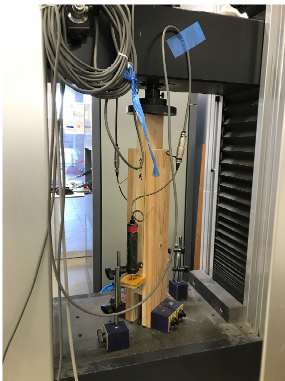
写真 11 ケヤキ せん断試験状況（繊維方向）
