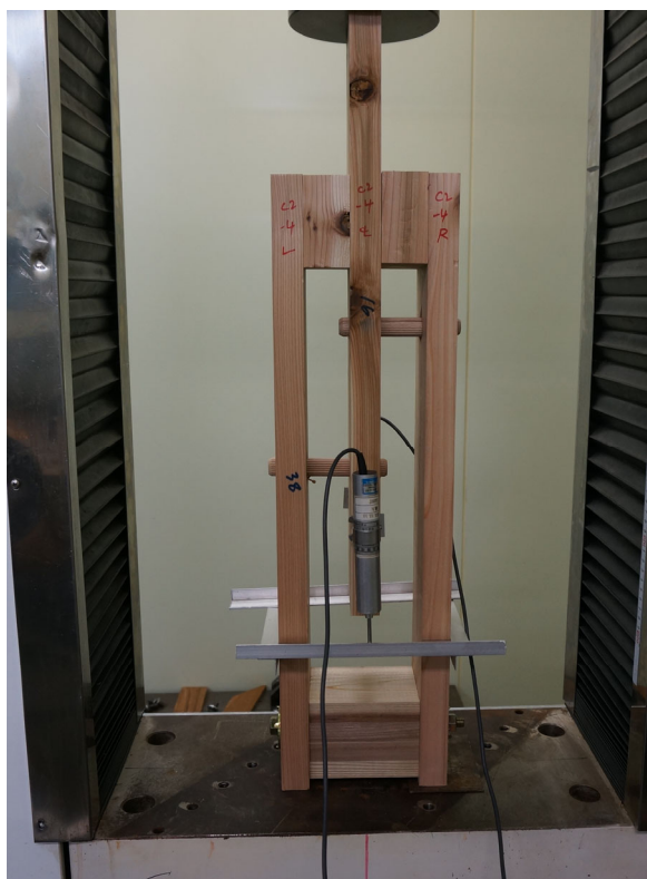
写真 18 C2 せん断試験状況
