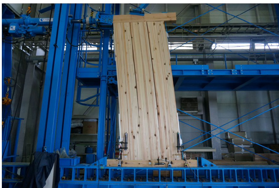
写真 26 試験体 B 面内せん断試験 終了時
