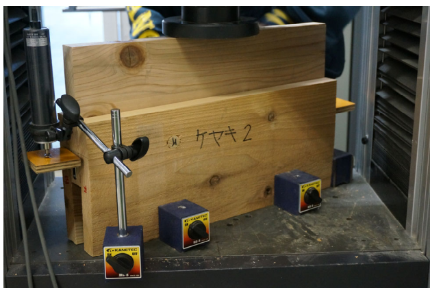
写真 14 ケヤキ せん断試験状況（繊維直角方向）
