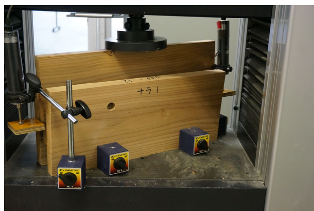
写真 16 ナラ せん断試験状況（繊維直角方向）
