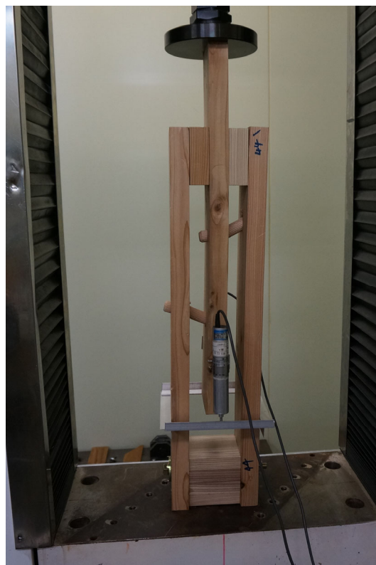
写真 17 C1 せん断試験状況
