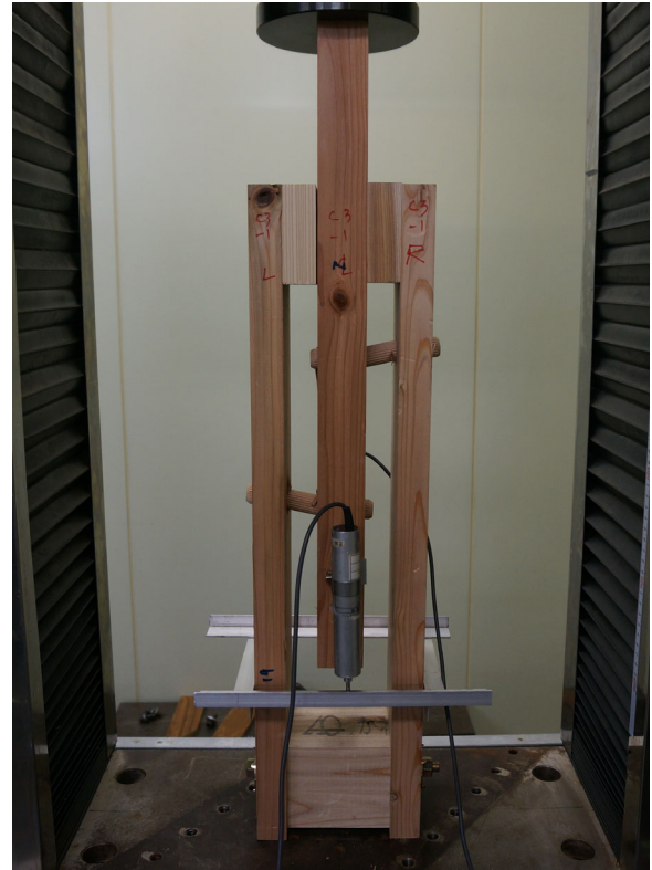
写真 19 C3 セン断試験状況
