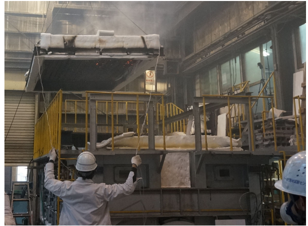
写真7 水平炉での加熱試験・脱炉状況
