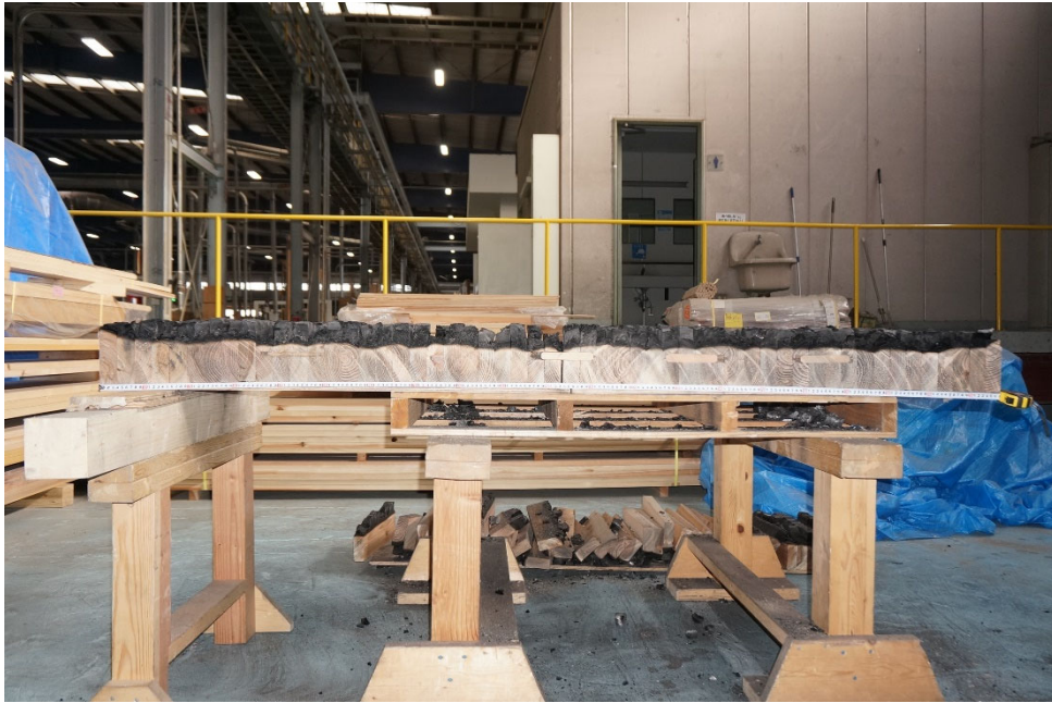
写真 66 試験体A スパン中央+455部 切断面
