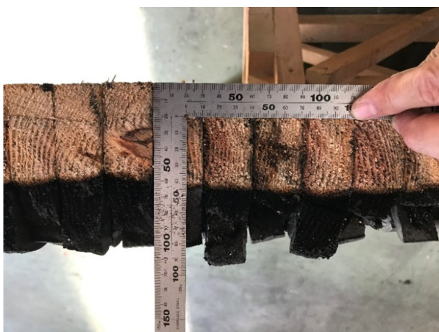
写真 39 試験体D（積層部の燃え込み）
