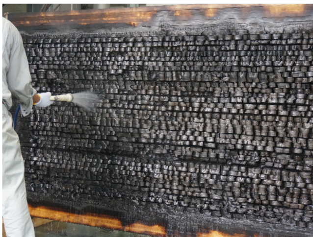
写真 19 試験体B (脱炉消火状況)
