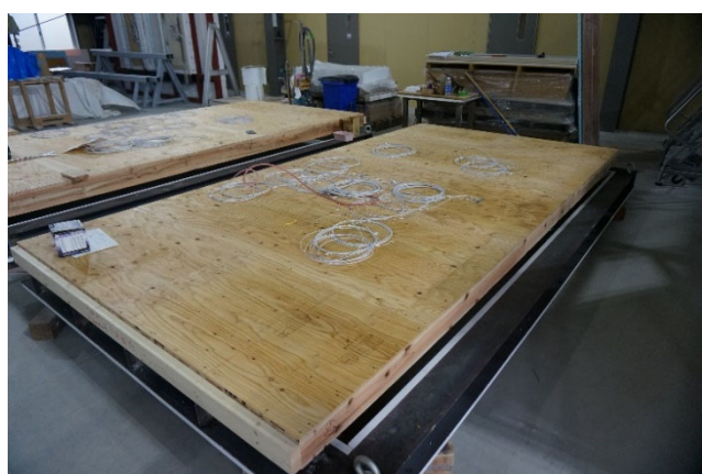
写真 51 熱電対取り付け完了
