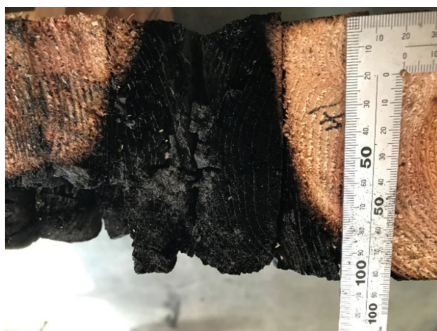
写真 40 試験体D（隙間部の燃え込み）
