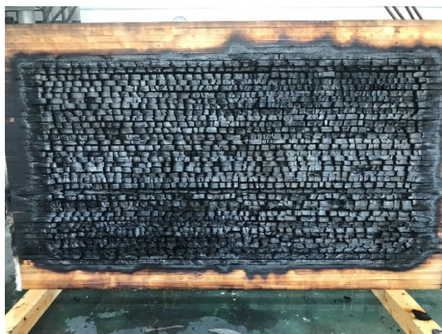
写真 38 試験体D（脱炉消火状況）
