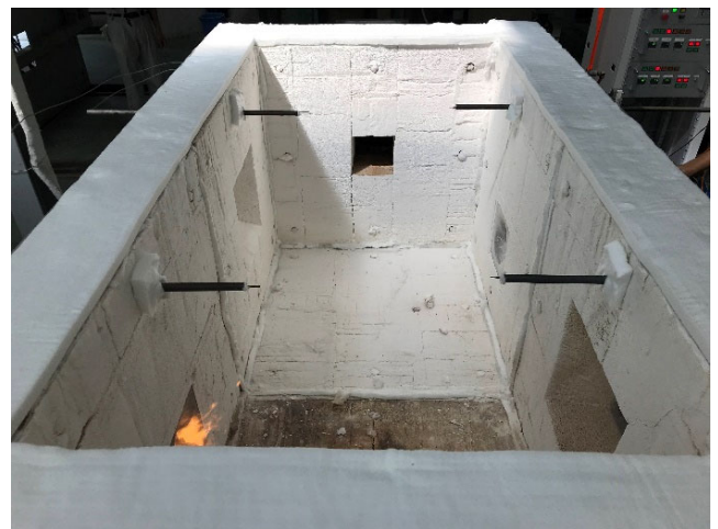
写真 5 小型加熱炉 内部
