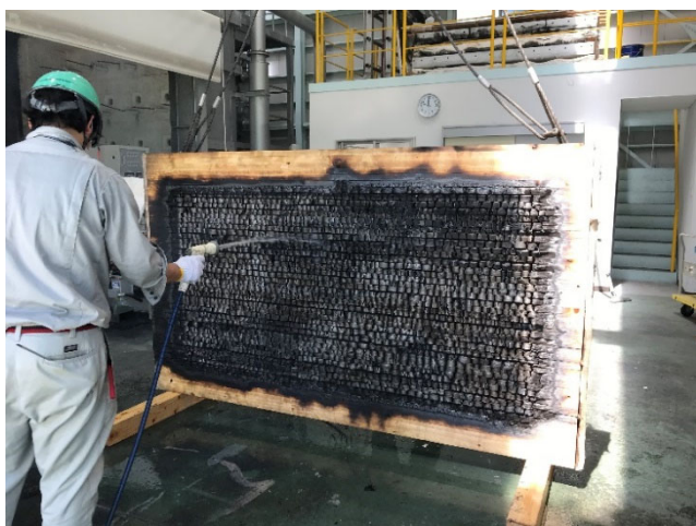
写真 27 試験体C (脱炉消火状況)
