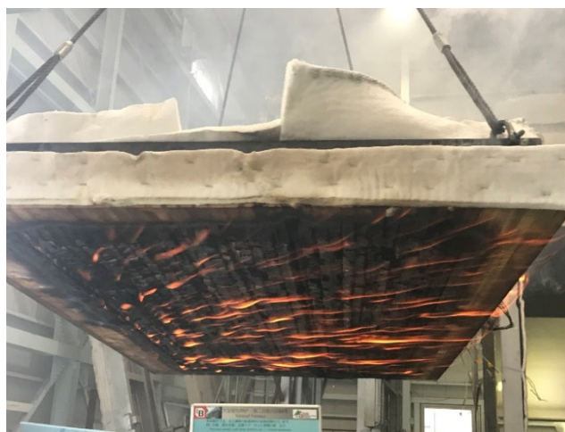
写真 36 試験体D (脱炉時)
