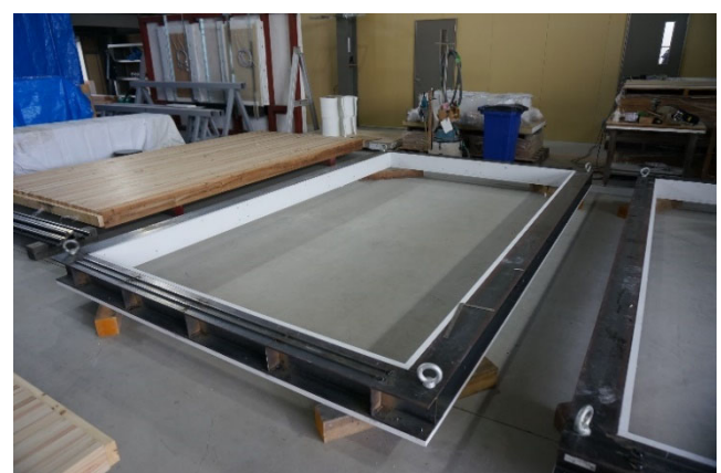
写真 48 試験体鋼製架台
