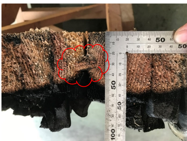
写真 41 試験体D（隙間部 雇い実）
