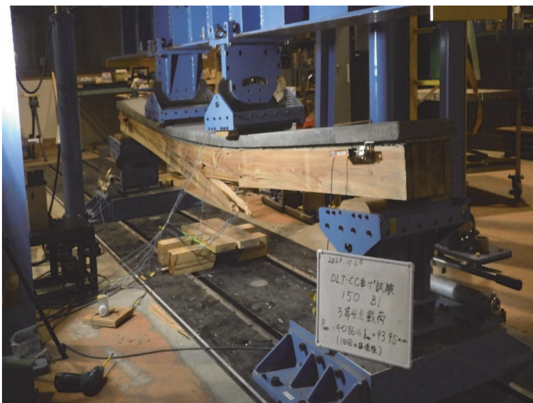
写真 3.4 - 5 DLT-CC 150 B1 加力後 破壊状況
