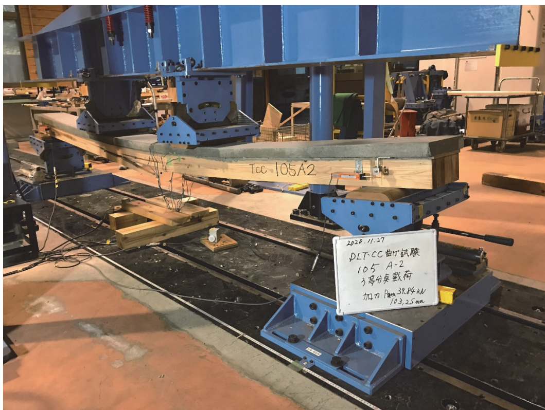
写真 3.4 - 3 DLT-CC 105 A2 加力後 破壊状況
