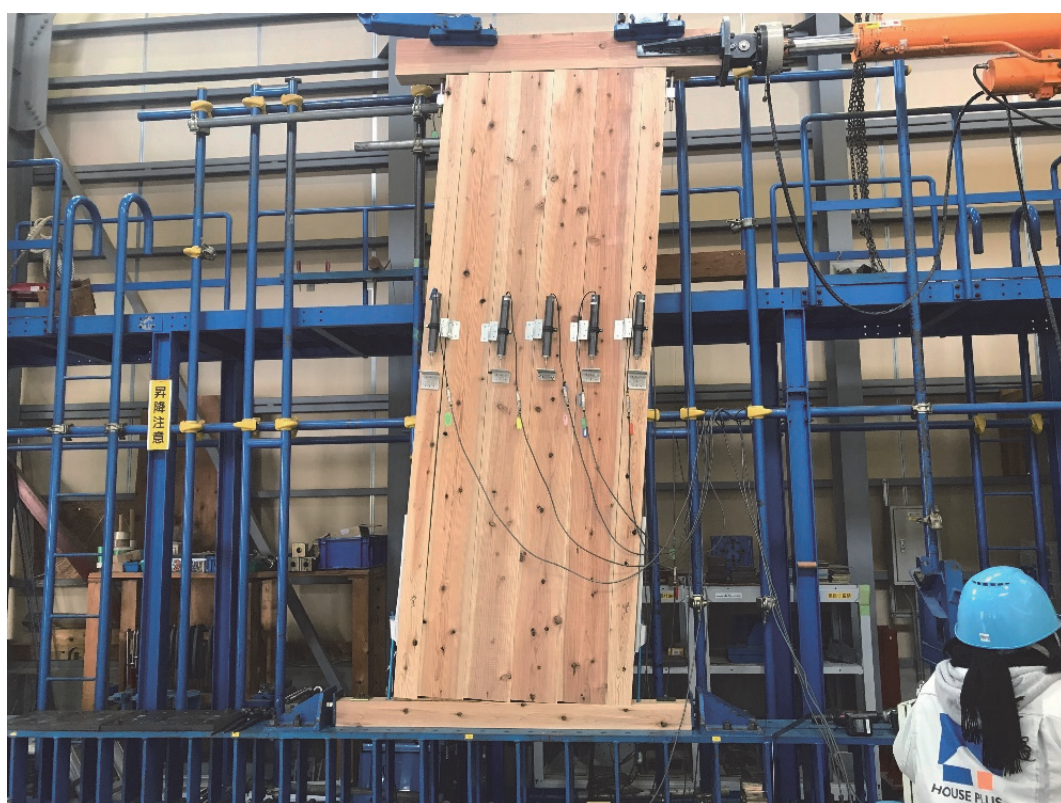
写真 4.2 - 2 面内せん断試験 加力後 (1/15 rad)
