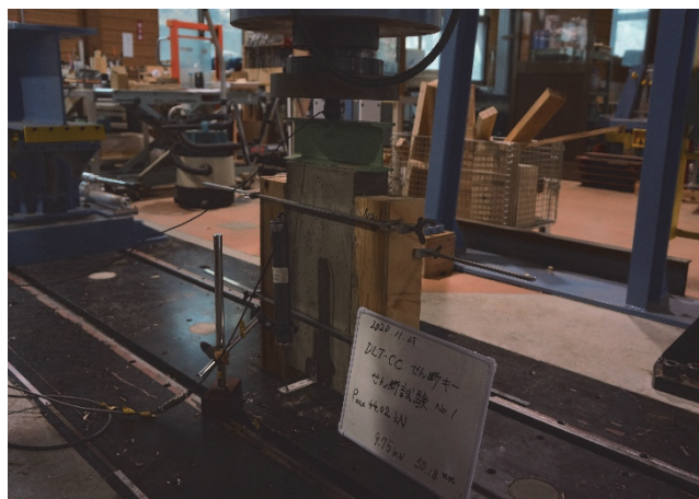
写真 2.3 - 2 試験体 No.1 加力後
