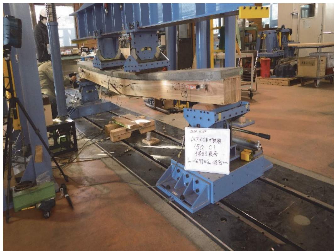
写真 3.4 - 6 DLT-CC 150 C1 加力後 破壊状況
