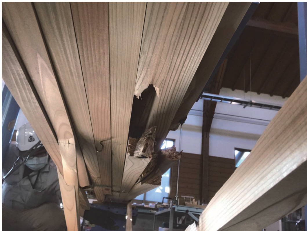
写真 3.1 - 6 曲げ破壊試験 180 C3 下面破壊状況の拡大
