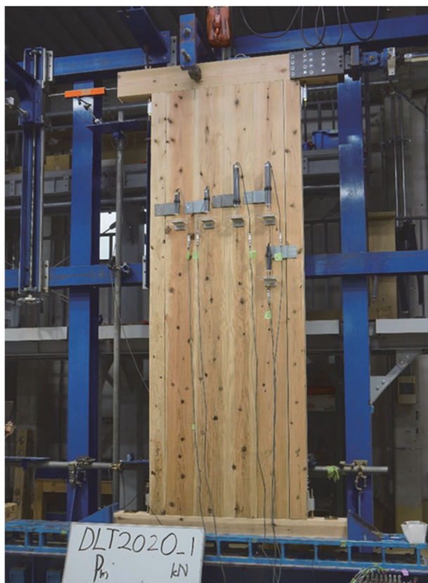
写真 4.1 - 1 面内せん断試験 加力前
