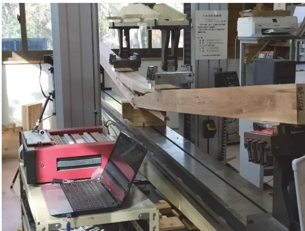
写真 3.2 - 1 試験体 A2-2 曲げ破壊の状況
