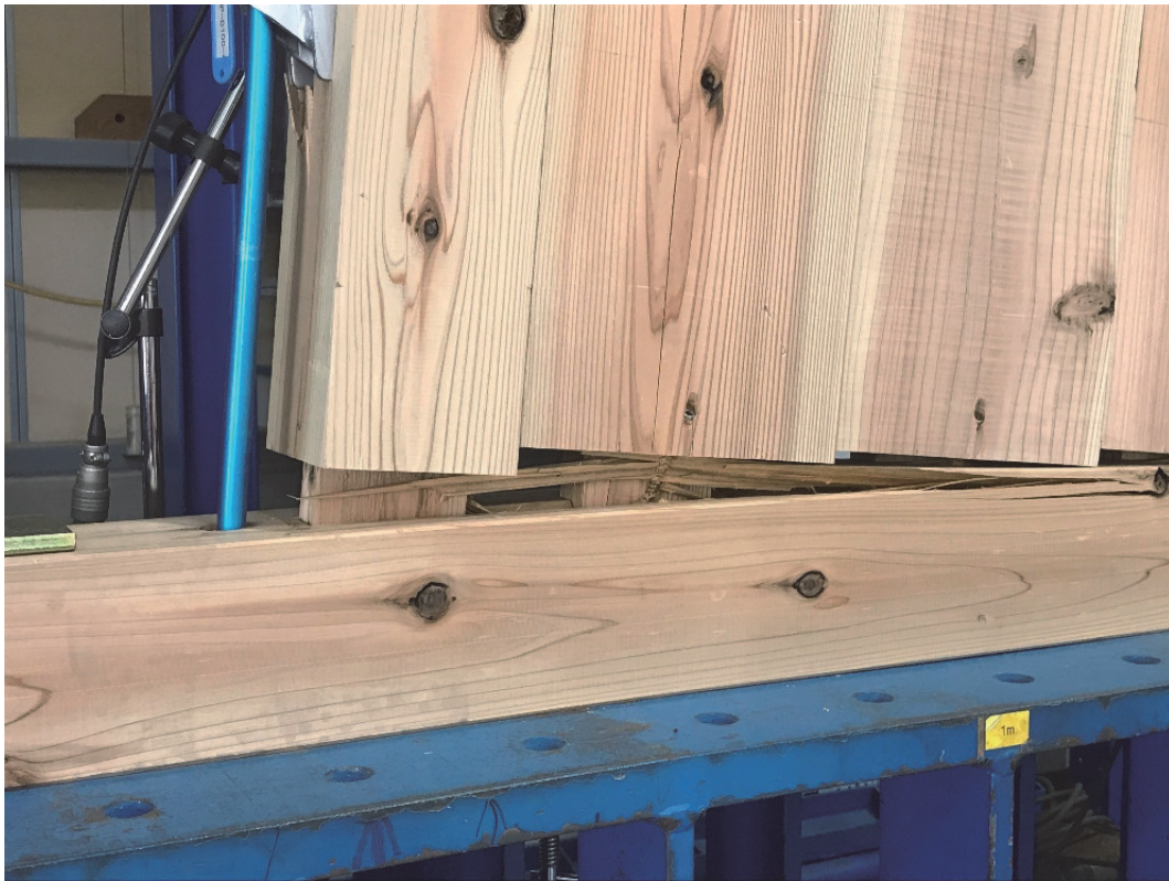
写真 4.2 - 3 最大加力時の柱脚部 (1/15 rad 時)
