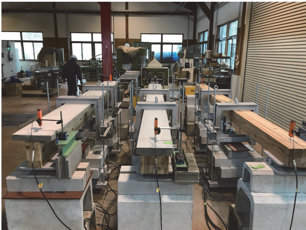
写真 3.5 - 1 クリープ試験 試験体の設置状況
