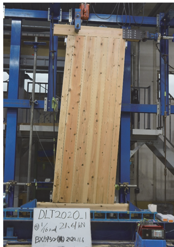
写真 4.1 - 2 面内せん断試験 加力前
