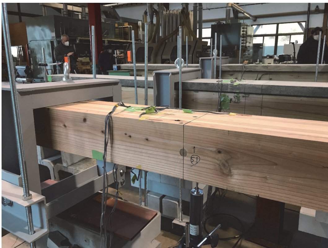
写真 3.5 - 2 クリープ試験 計測器設置状況
