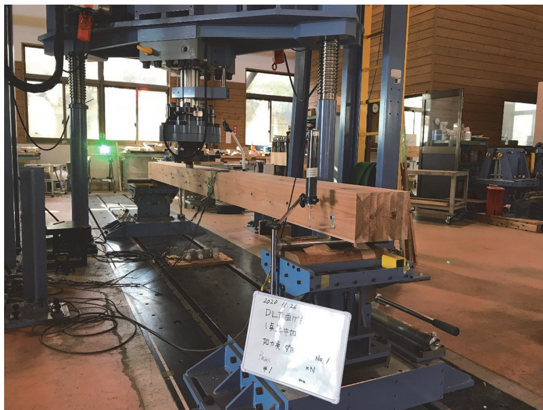
写真 3.1 - 2 1点集中荷重 加力試験 全景
