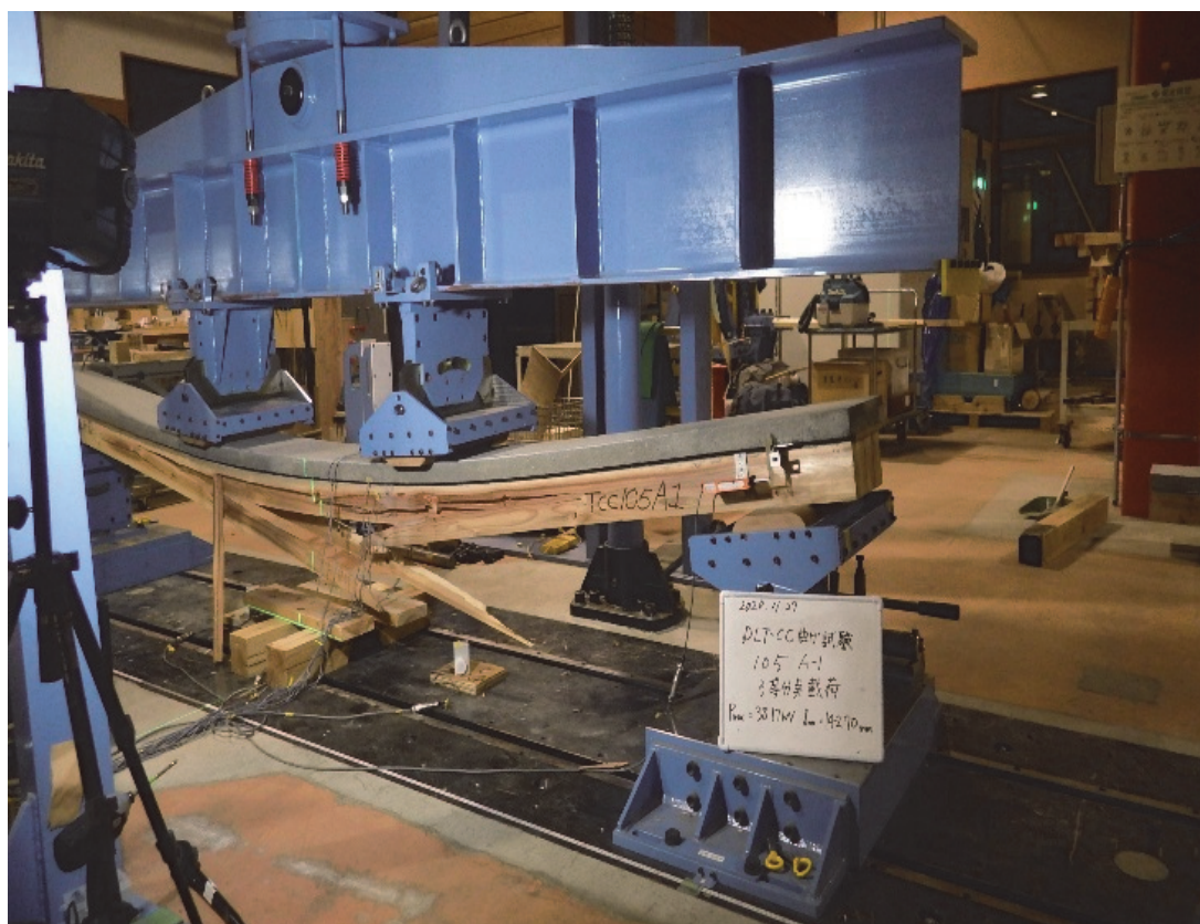
写真 3.4 - 2 DLT-CC 105 A1 加力後 破壊状況
