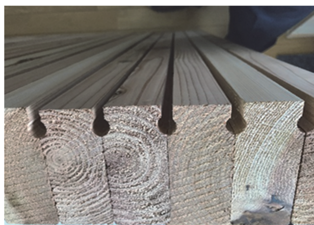
写真 5 - 3 吸音試験体 A1 断面
