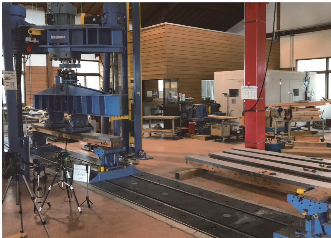
写真 3.4 - 1 DLT-CC 曲げ破壊試験 全景
