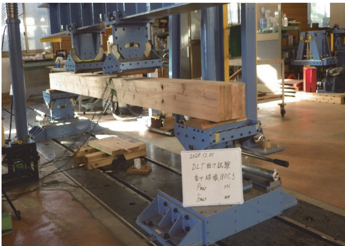
写真 3.1 - 3 曲げ破壊試験 全景
