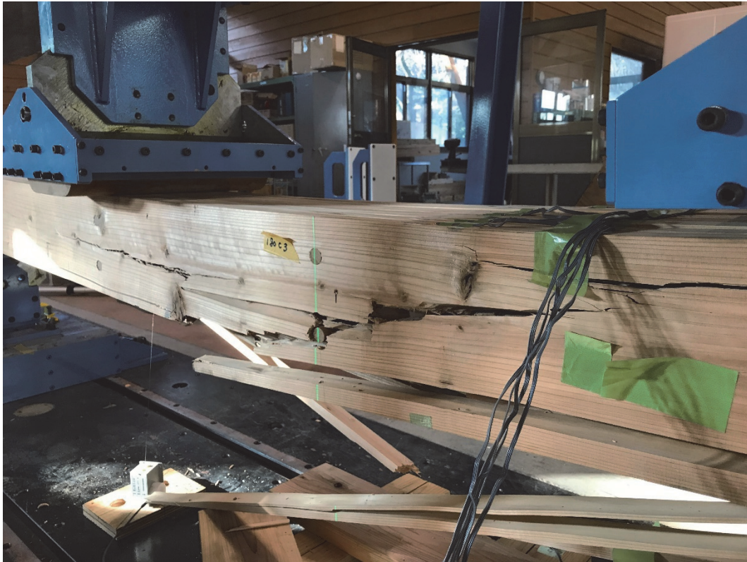
写真 3.1 - 5 曲げ破壊試験 180 C3 破壊状況の拡大
