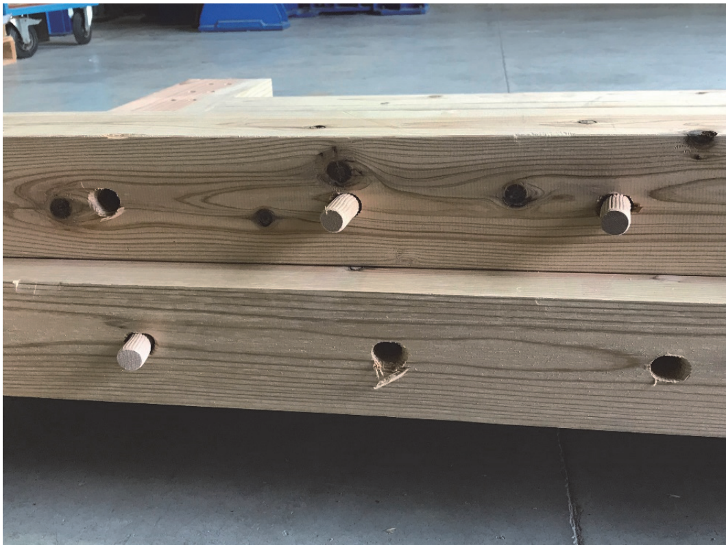
写真 4.2 - 4 試験後の軸組との木ダボ接合部
