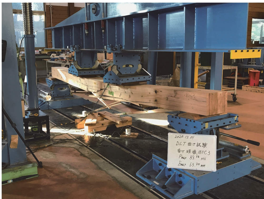
写真 3.1 - 4 曲げ破壊試験 180 C3 破壊状況
