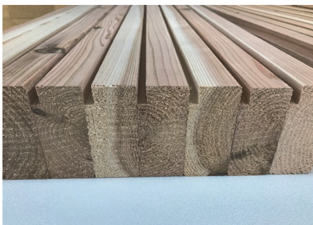
写真 5 - 9 吸音試験体 B1 断面
