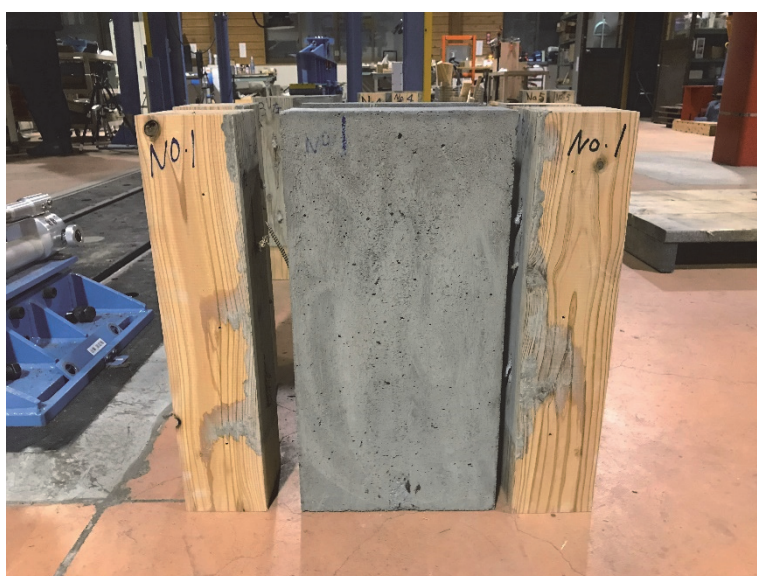
写真 2.3 - 3 試験体 No.1 解体
