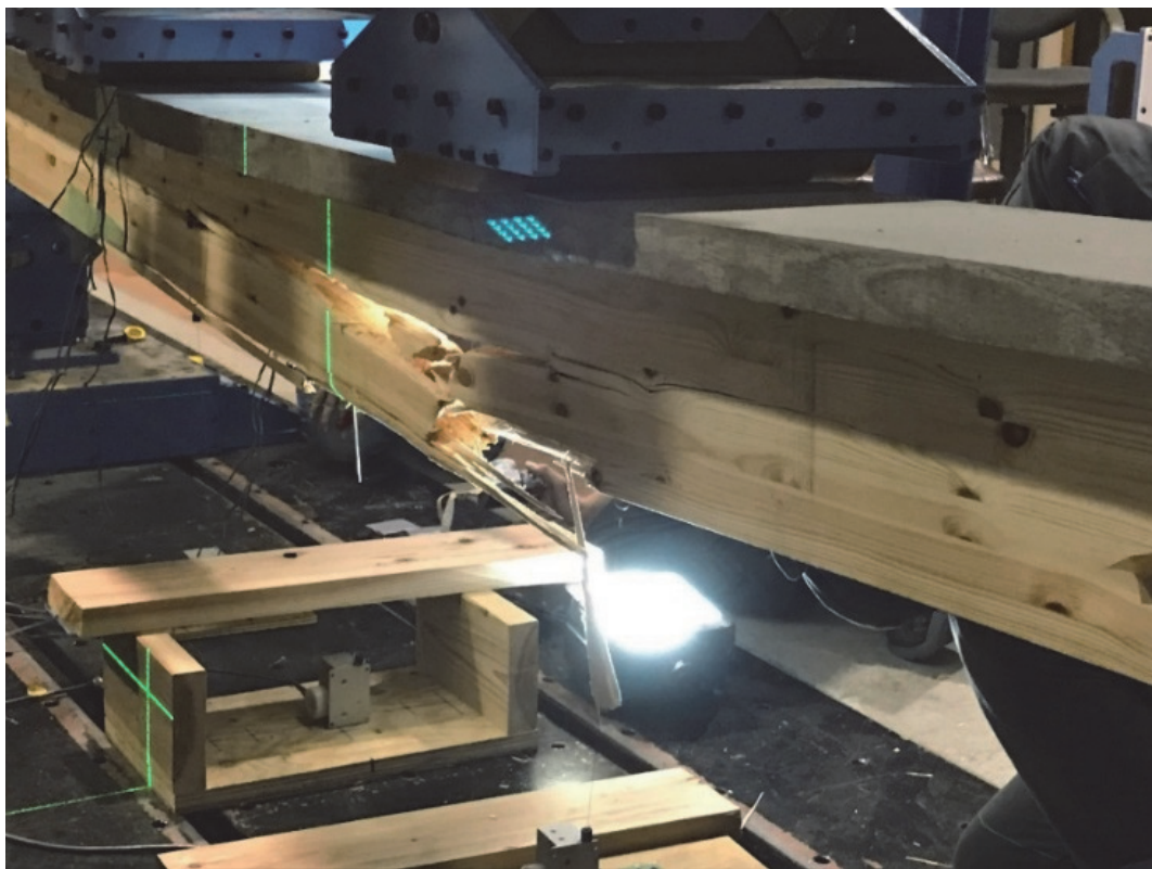
写真3.3 - 6 破壊状況 拡大
