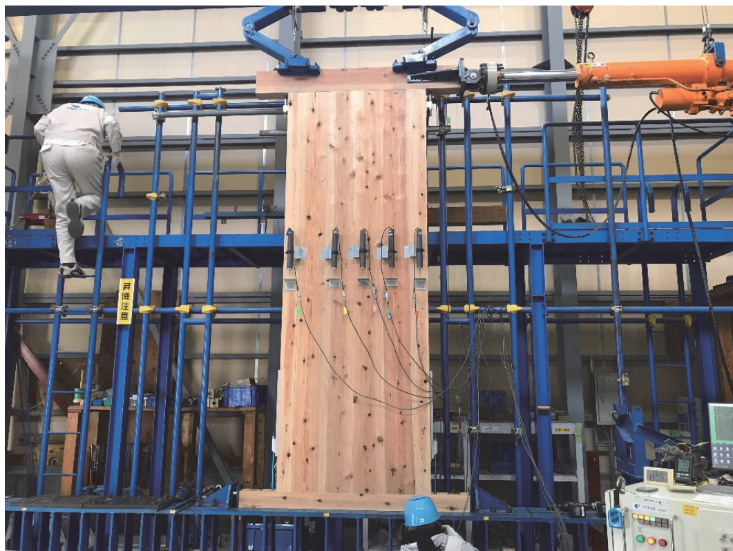
写真 4.2 - 1 面内せん断試験 加力前
