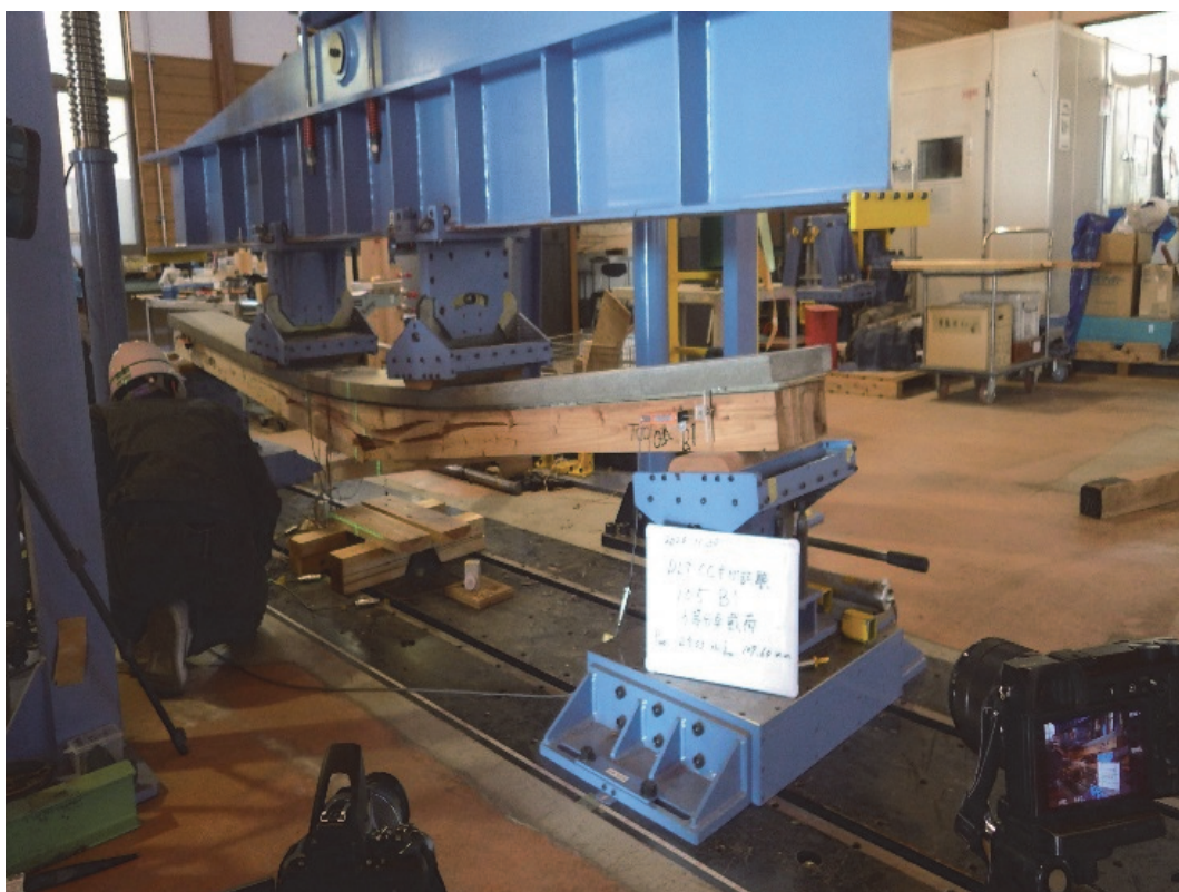
写真 3.4 - 4 DLT-CC 105 B1 加力後 破壊状況
