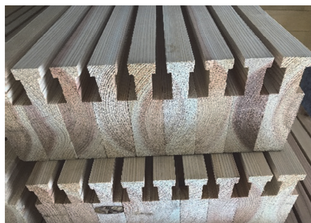
写真 5 - 5 吸音試験体 A2 断面
