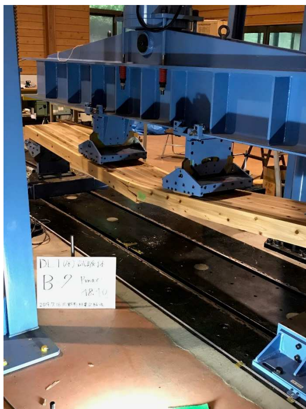
写真-5-13 試験体 B2 曲げ破壊状況
