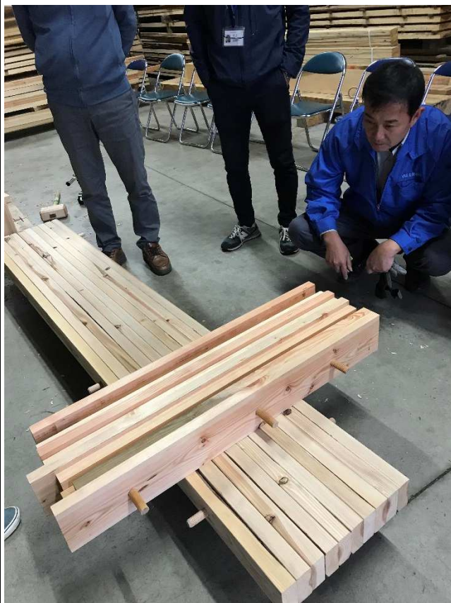
写真-9-17 異樹種積層材、スギ積層材の外観の確認（表側）
