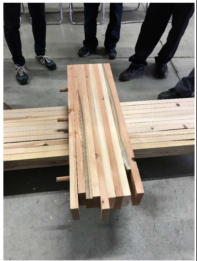
写真-9-18 異樹種積層材、スギ積層材の外観の確認（裏側）
