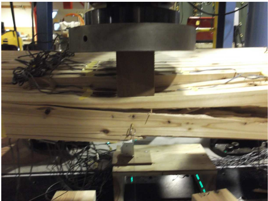
写真-6-5 曲げ破壊の状況 2
