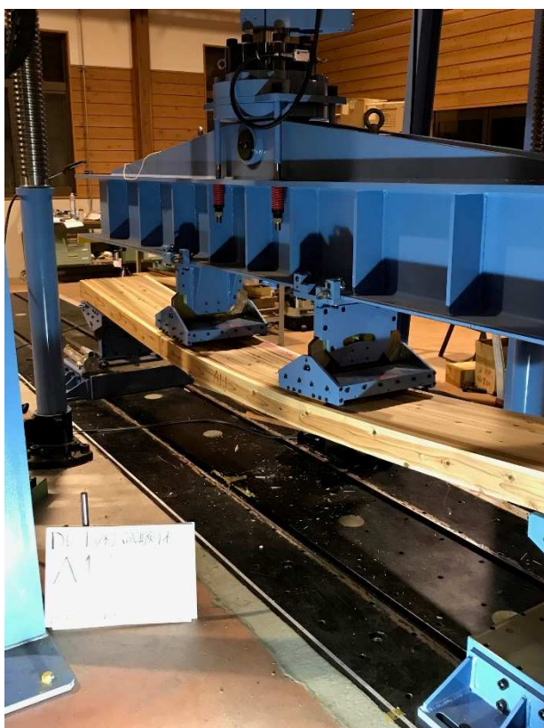
写真- 5-4 試験体 A1-1 曲げ破壊の状況
