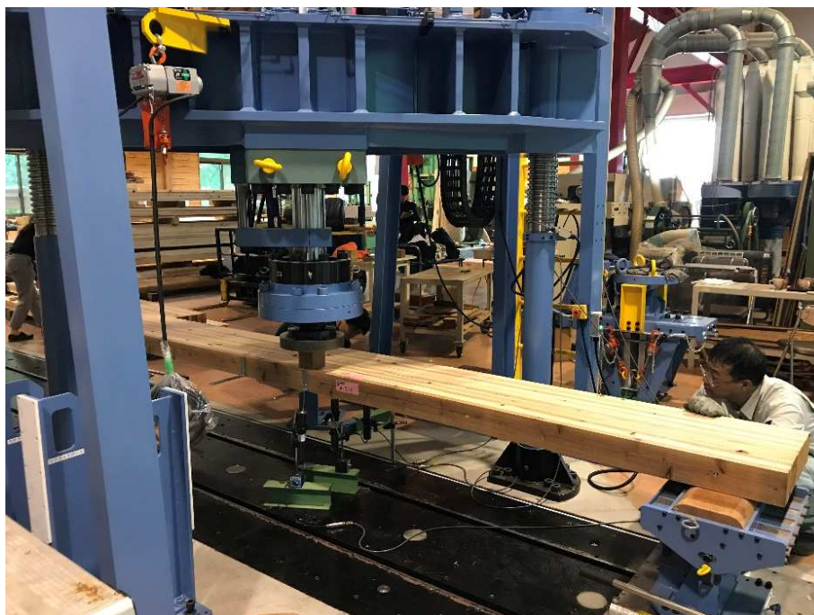
写真-5-1 試験状況（集中荷重の荷重載荷）
