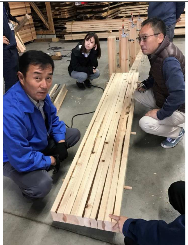
写真-9-12 木ダボ積層材の外観確認（大貫委員、小井土委員）
