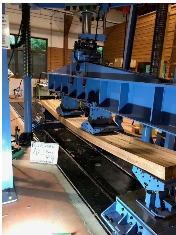
写真- 5-9 試験体 A2-2 曲げ破壊の状況
