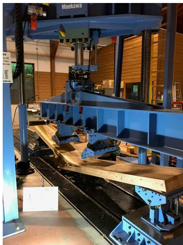
写真-5-12 試験体 B1 曲げ破壊状況
