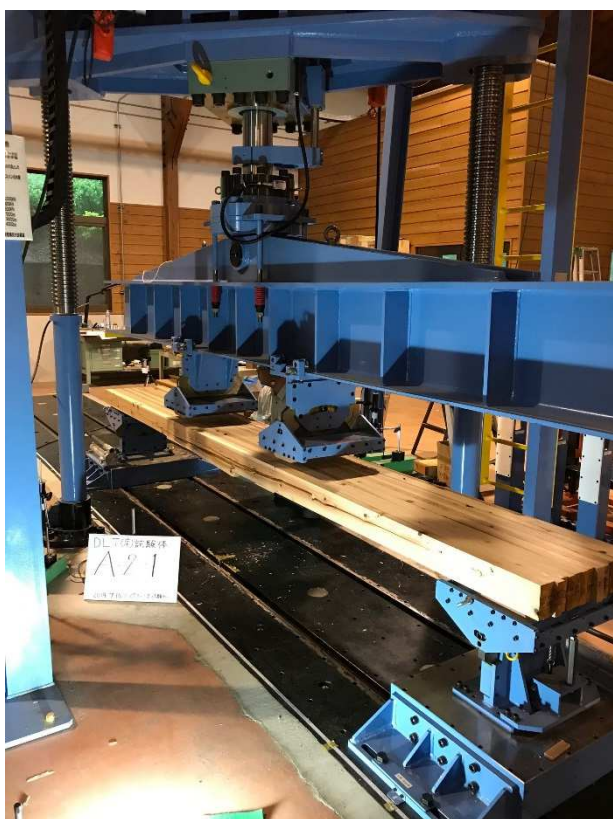
写真- 5-8 試験体 A2-1 曲げ破壊状況
