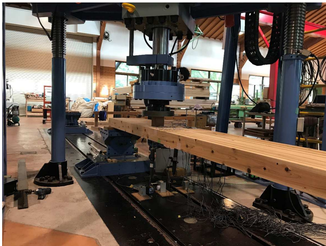
写真-6-2 集中荷重載荷時の状況
