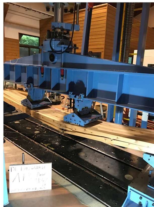
写真- 5-7 試験体 A1-2 曲げ破壊の状況
