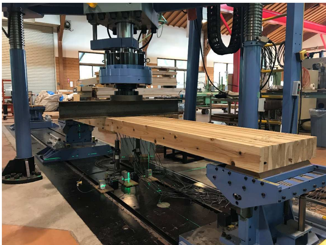
写真-6-1 H 鋼荷重載荷時の状況
