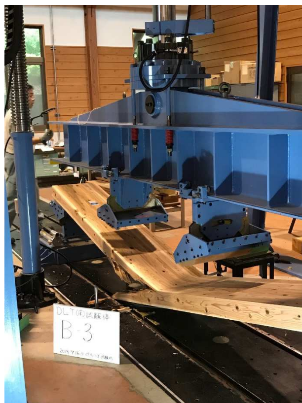
写真-5-14 試験体 B3 曲げ破壊状況
