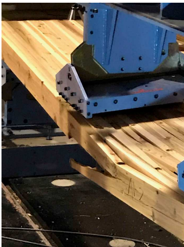
写真- 5-6 試験体 A1-3 曲げ破壊の状況 拡大
