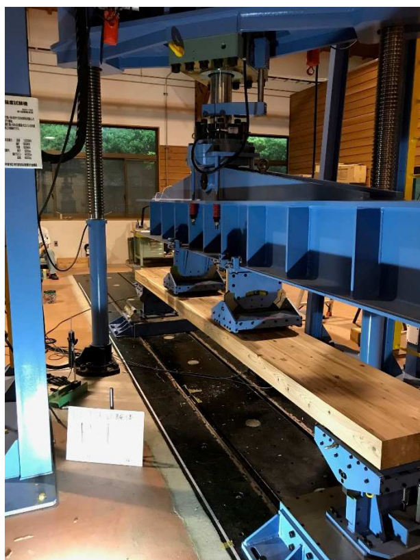
写真-5-11 曲げ破壊試験の状況
