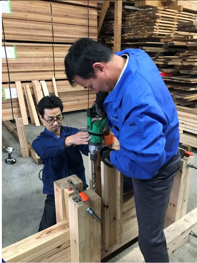
写真-9-5 小井土委員による孔あけ加工
