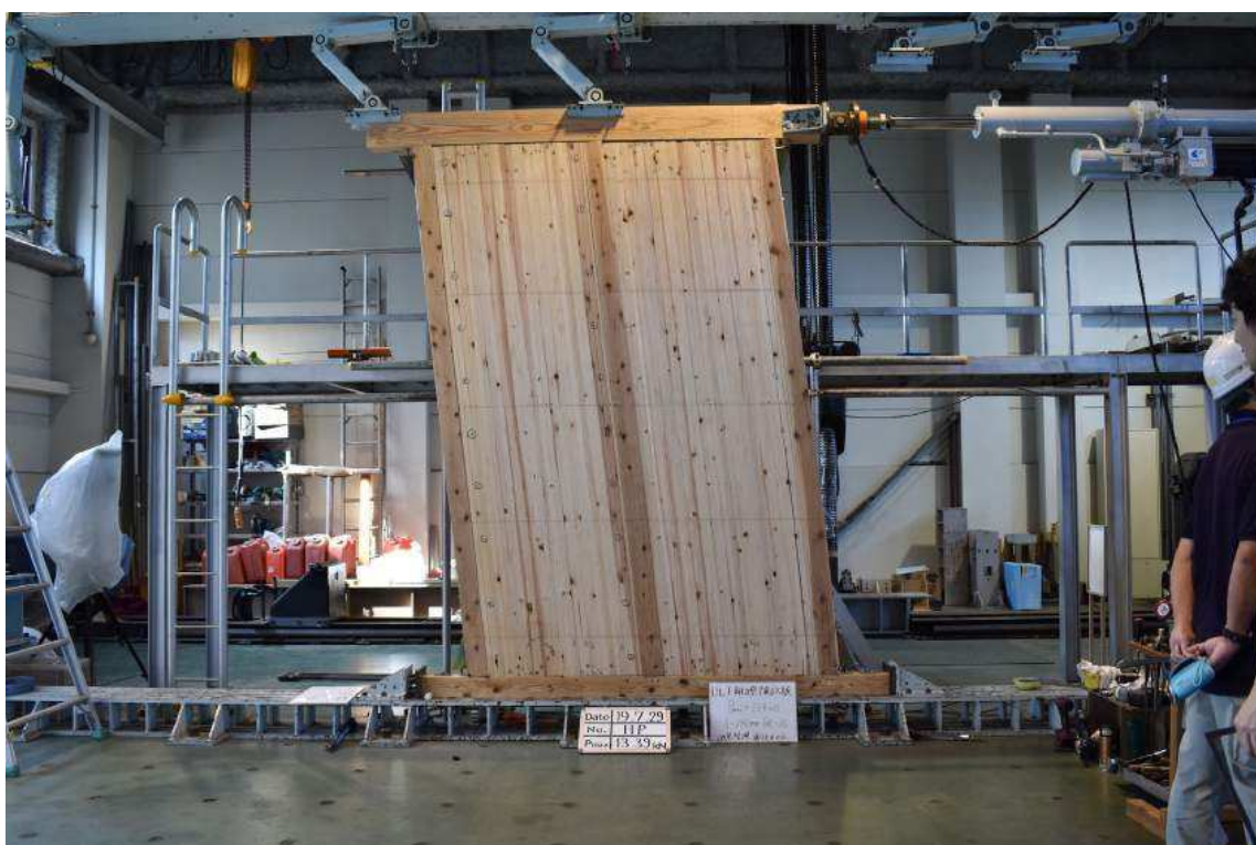
写真- 7-2 面内せん断試験 加力後
