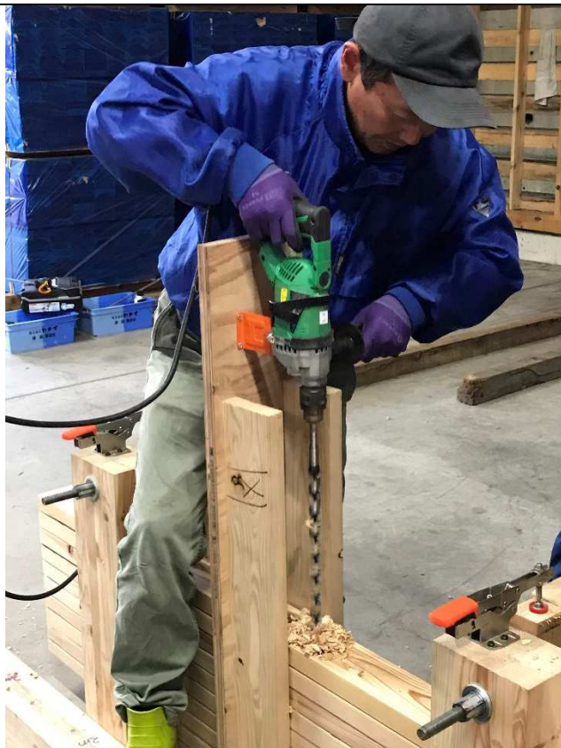
写真-9-7 小井土製材 社員による孔あけ加工
