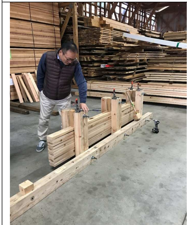
写真-9-3 積層・圧締途中での確認（大貫委員）
