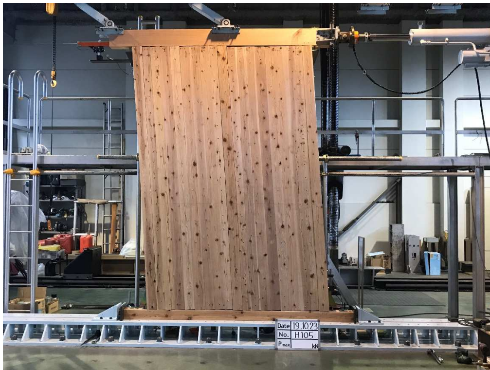
写真- 8-2 面内せん断試験 加力後
