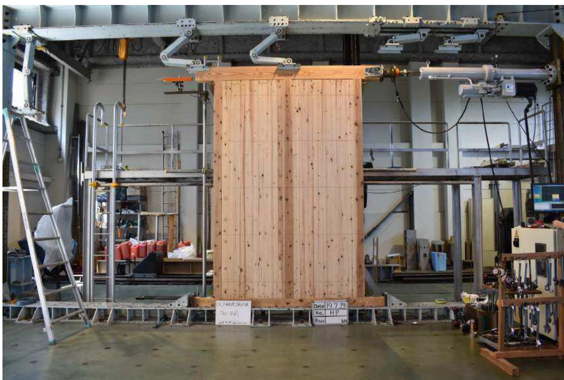
写真-7-1 面内せん断試験 加力前
