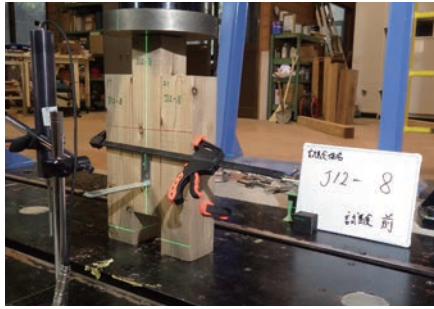
接合部せん断試験（事故的水かかき処理後）
