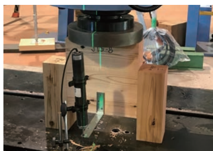
接合部のせん断試験
