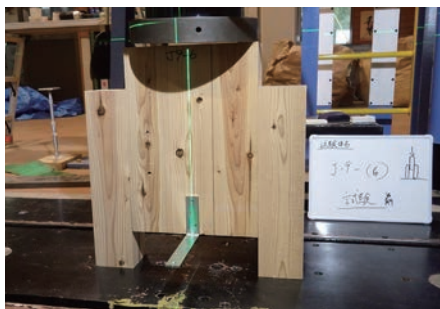
接合部のせん断試験
