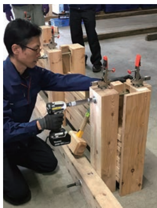
積層・圧縮の状況
