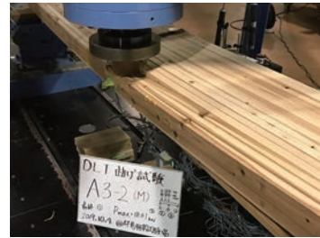
曲げ破壊の状況 1
