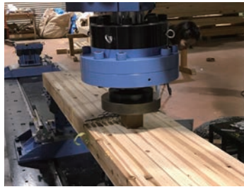
集中荷重載荷時の状況
