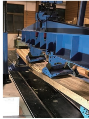
曲げ試験 破壊状況
